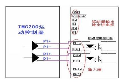
共阳极接法如下图所示。本例以第三轴为例子,其他轴的方向正和脉冲正都是从控制器的+5V端口取,连到驱动器的DIR+和PUL+。
